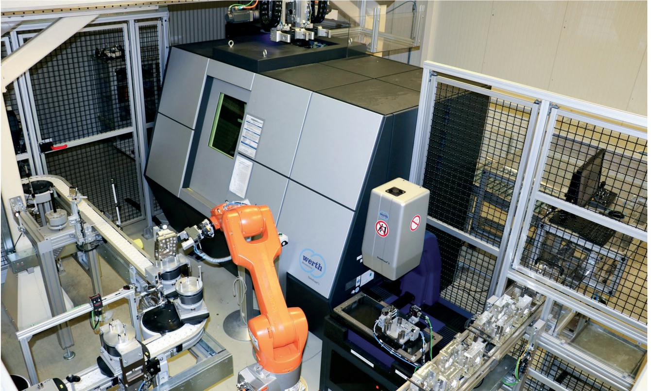
Bild 1. Voll automatisierte Messzelle mit Röntgentomografie- (links) und optischem Koordinatenmessgerät (rechts) © Werth
